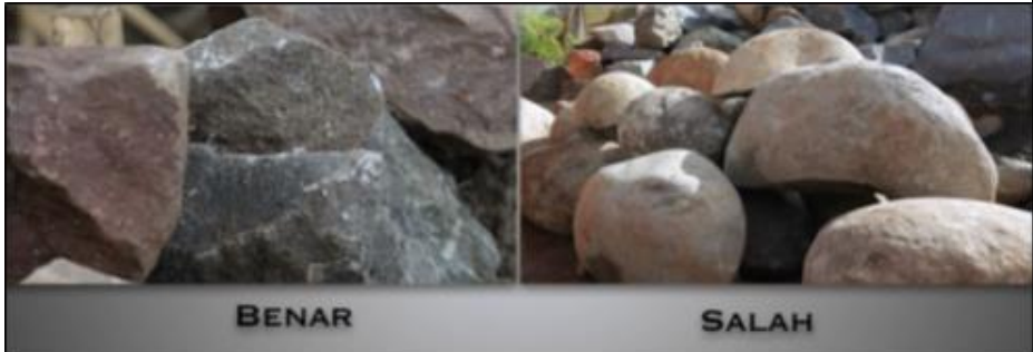
Gambar 10. Kualitas Batu Kali/Gunung yang Baik Digunakan Sebagai Pondasi
