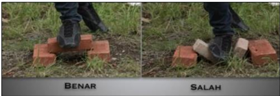
Gambar 13. Pengujian Sederhana Kekuatan Batu Bata
