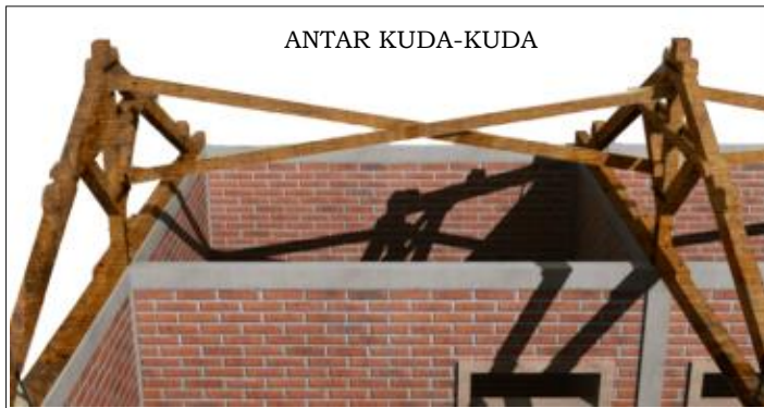
Gambar 34. Ikatan Angin Sebagai Pengikat Antar Kuda-Kuda Kayu
