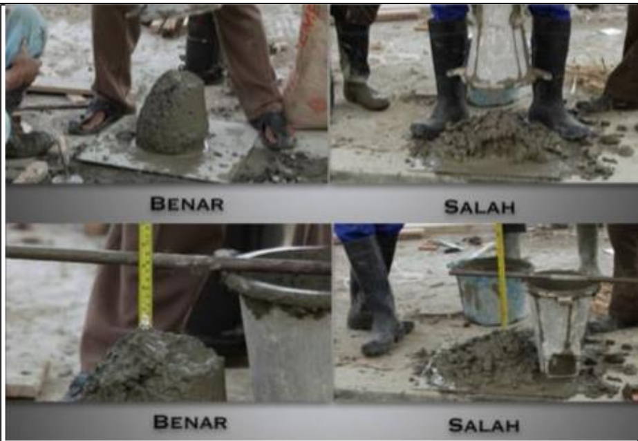
Gambar 4. Pengujian Sederhana Dengan Menggunakan Cetakan dan Mengukur Selisih Ketinggian dengan Cetakan
