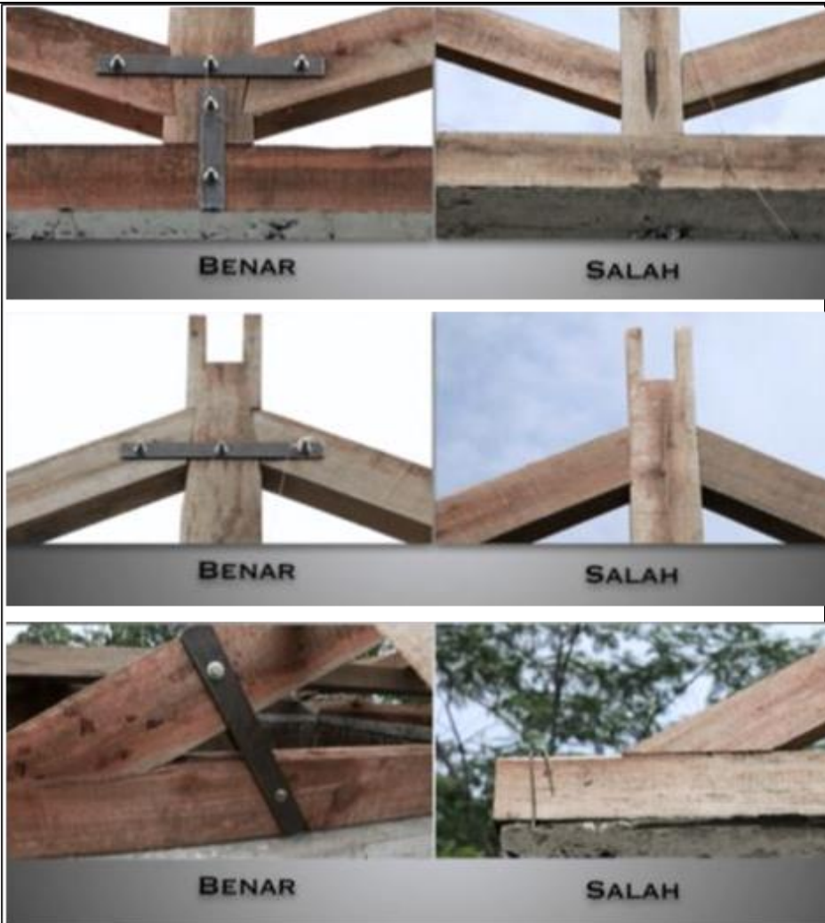
Gambar 29. Pemasangan Plat Baja Pada Kuda-kuda Kayu
